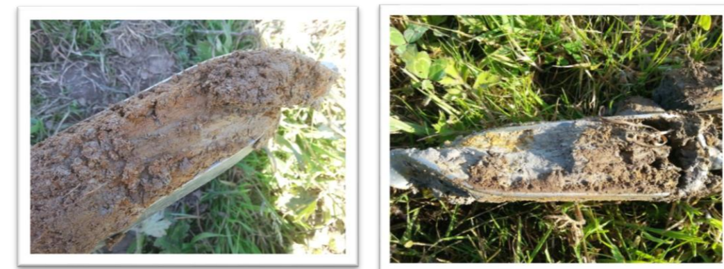
Photo 8 : Exemples de carottes avec des traits rédoxiques (à gauche) et des traits réductiques (à droite)
