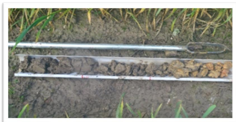
Photo 7 : Exemple de carottage sur une profondeur de 120 cm
